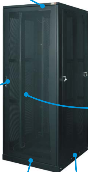
TFE-428010-PPPP-BK Напольный шкаф 19", 42U, перфорированная дверь, Ш800×В2101×Г1000 мм, в собранном виде, черный
